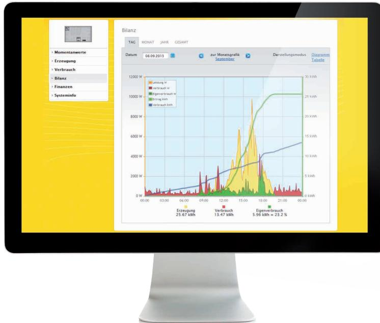
Solar-Log™ ist das intelligente Energie-Management-System für Photovoltaik-Anlagen. Der Eigenverbrauch wird angezeigt, dargestellt und effizient gesteuert. Unter „Bilanz“ wird die Erzeugung und der Verbrauch der PV-Anlage in Relation zueinander dargestellt.
