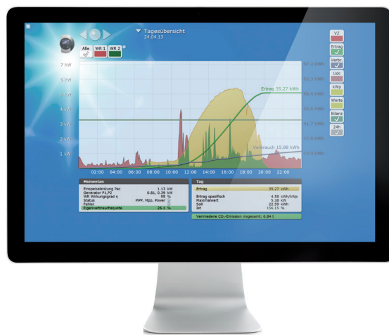
Tagesübersicht mit Darstellung der Ertrags- und Verbrauchsbilanz, 1 Wechselrichter. Strombezug (rot), Stromproduktion (gelb), Eigenstrom (grün).
