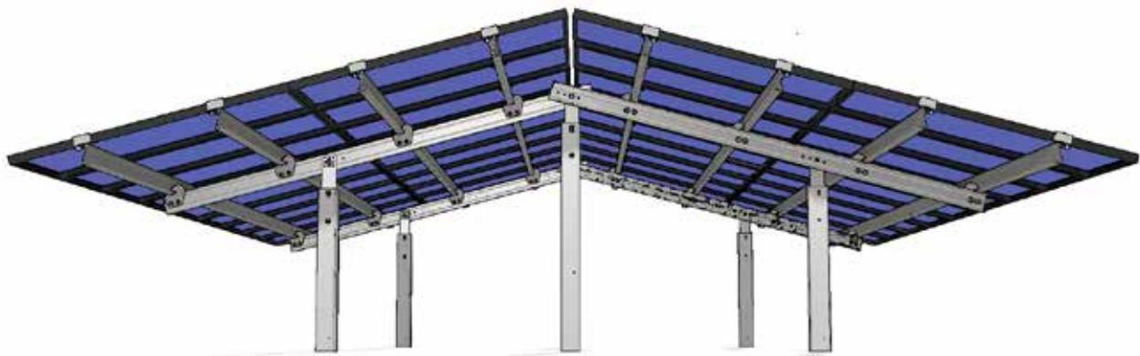
Das neue FS Duo100 ist, wie das System FS Uno100, für eine Ost-West-Ausrichtung der Module ausgelegt. Es ermöglicht gegenüber dem FS Uno100 allerdings die Aufnahme höherer Belastungen bzw. die Ausführung größerer Modulflächen. Bedingt durch die Drei-Stützen-Anordnung sind größere Stützenabstände und somit tiefere Modulsegel realisierbar.
